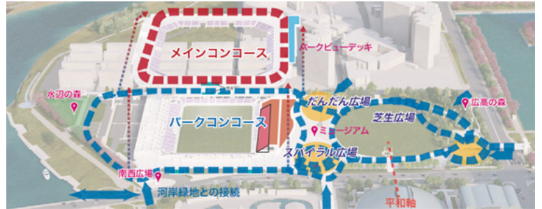
スタジアムと広場をつなぐダブルコンコース(コンコースの2層化)
